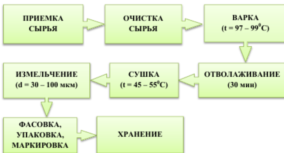
Рисунок 3.2. Технологическая блок – схема получения концентрата из семян маша
