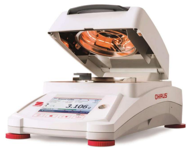
Рисунок 2.3. Влагоанализатор фирмы OHAUS работающий на основе микроволн
