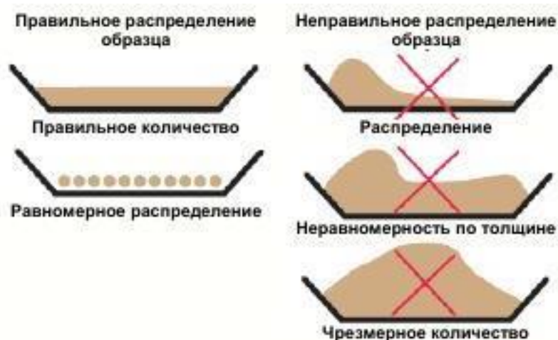
Рисунок 2.4. Примеры правильного и неправильного распределения образца в чашке влагоанализатора OHAUS
