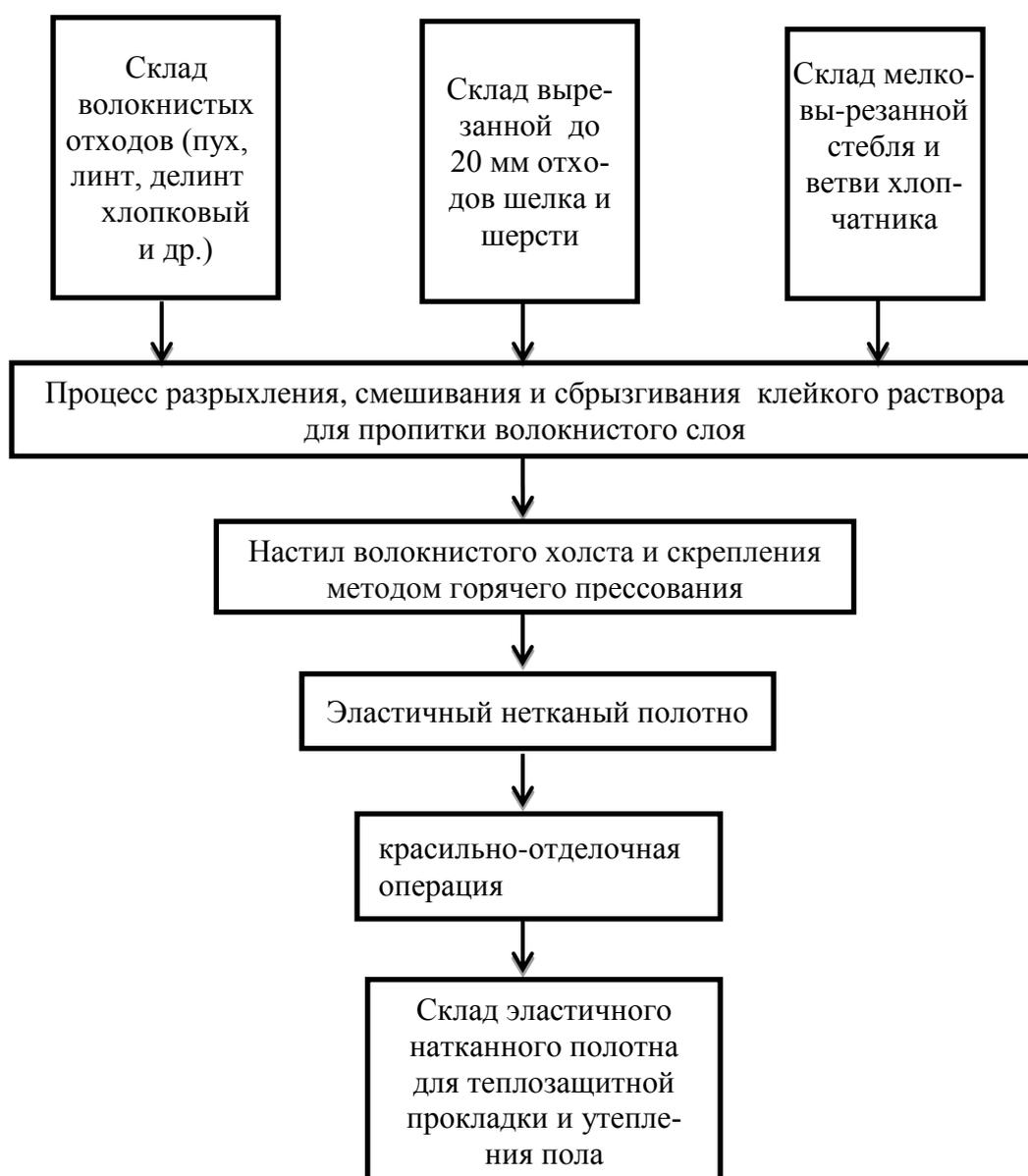
Рисунок 4.4 - Схема линии хлопкозавода по производству эластичного нетканого полотна для теплозащитной прокладки и утепления пола
