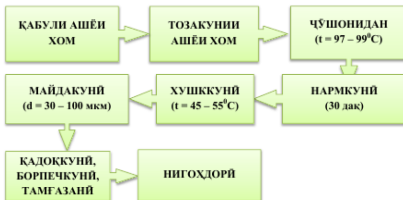
Расми 2. Блок – схемаи технологии ба даст овардани концентрат аз донаҳои мош
