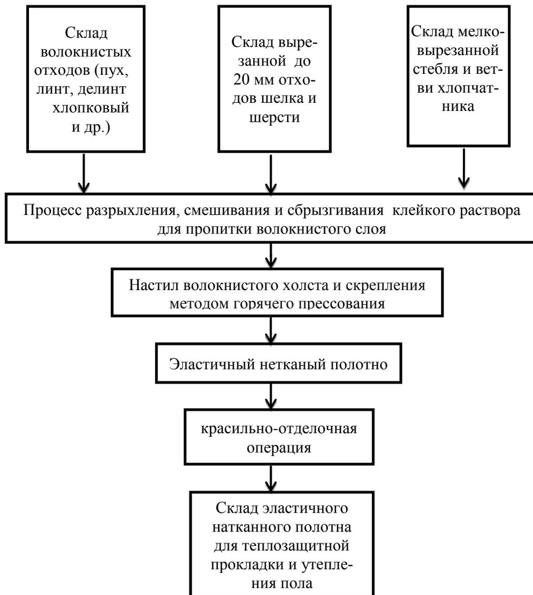
**Рисунок 16.** - Линия хлопкозавода по производству эластичнонетканого полотна для теплозащитной прокладки и утепления пола
