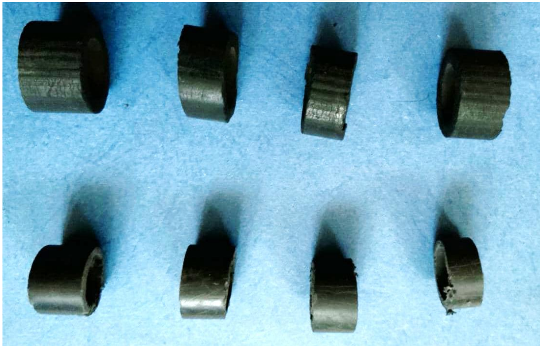
Рисунок 3.3.- Фотоснимки элементов рекомендуемого тарелчатого нитенатяжителя (а), а также резиновых втулок с различной шириной (жесткостью) (б).
