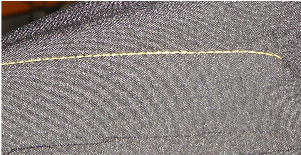
Рисунок 4.3.- Общий вид сшиваемых джинсовых материалов “Деним” в рекомендуемой модернизированной швейной машины с новыми нитенатяжителями
