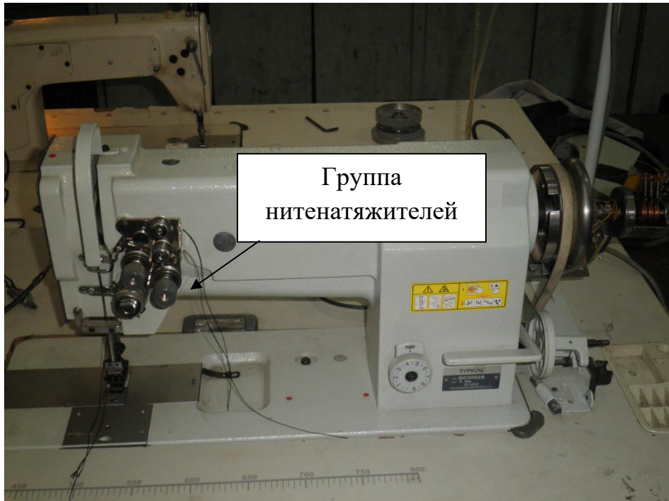
Рисунок 3.1. - Общий вид швейной машины с механизмами подачи и регулирования натяжения нити.
