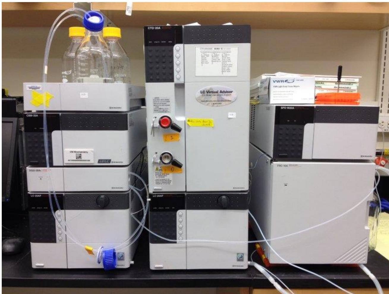
**Рисунок 2.4.3.1. – Высокоэффективной жидкостной хроматографии (ВЭЖХ Prominence, Shimadzu LC-20, Торранс, Калифорния, США).**
