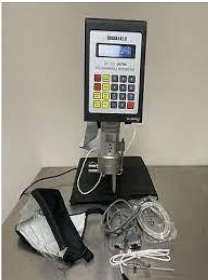
**Рисунок 2.4.7.1. – Ультрапрограммируемый реометр DV-III (Brookfield Engineering Laboratories Inc., США)**
