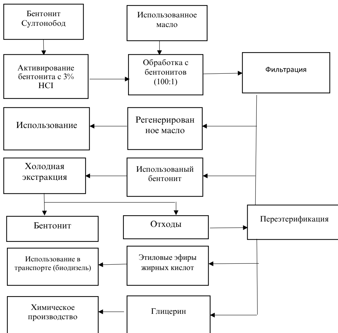
Рисунок 4. – Технология регенерации использованных пищевых растительных масел
