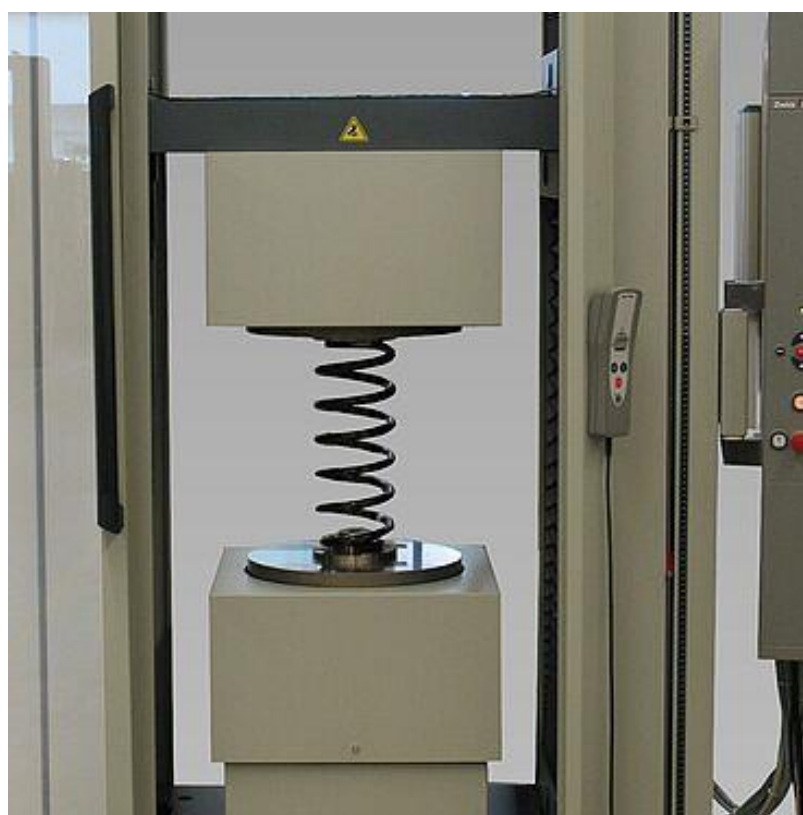
Рисунок 3.5. - Образцы пружин растяжения и общий вид установки: а-образцы пружины сжатия; б-общий вид экспериментальной установки.
