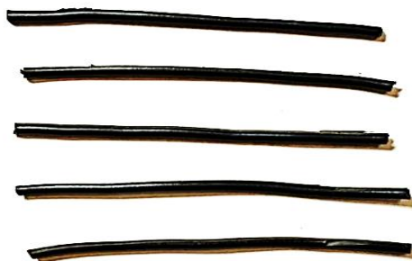
Рисунок 3.6.- Образцы резиновых трубок для изготовления втулок для шарнира механизма иглы.
