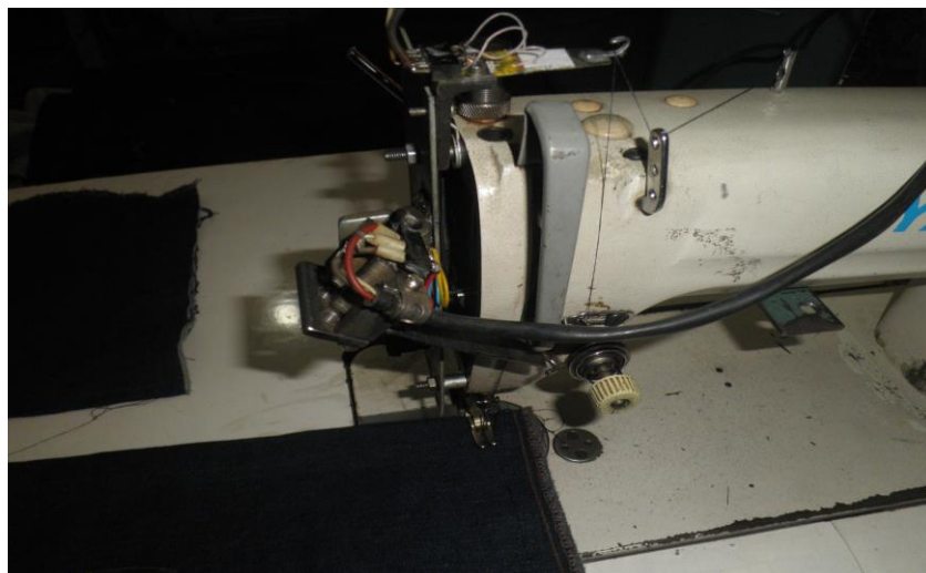
Рисунок 3.3.- Общий вид механизма иглы с пружиной растяжения и составным шарниром с датчиками измерения, установленный в швейной машины
