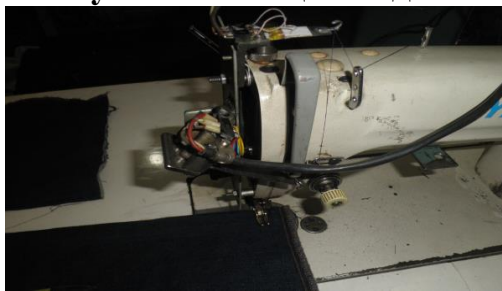
Рисунок 4.- Общий вид механизма иглы с пружиной растяжения и составным шарниром с датчиками измерения, установленный в швейной машины
