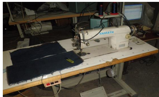
Рисунок 4.- Общий вид механизма иглы с пружиной растяжения и составным шарниром с датчиками измерения, установленный в швейной машины
