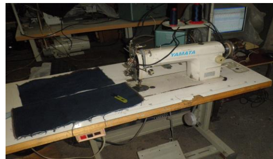
Расми 4.- Намуди умумии механизми сӯзан бо пружинаи кашиш ва шарнири композитӣ бо ченкунакҳои дар мошини дарздӯзӣ насбшуда
