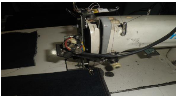
Расми 4.- Намуди умумии механизми сӯзан бо пружинаи кашиш ва шарнири композитӣ бо ченкунакҳои дар мошини дарздӯзӣ насбшуда
