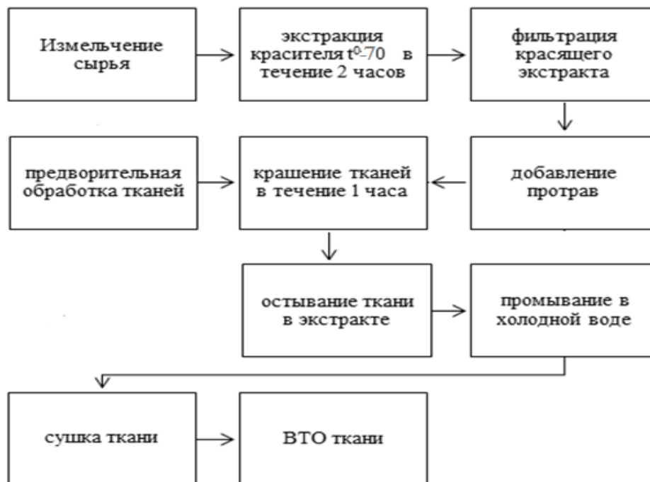
Рисунок 14. –Технологическая схема крашения целлюлозных тканей растительными красящими экстрактами протравным методом
