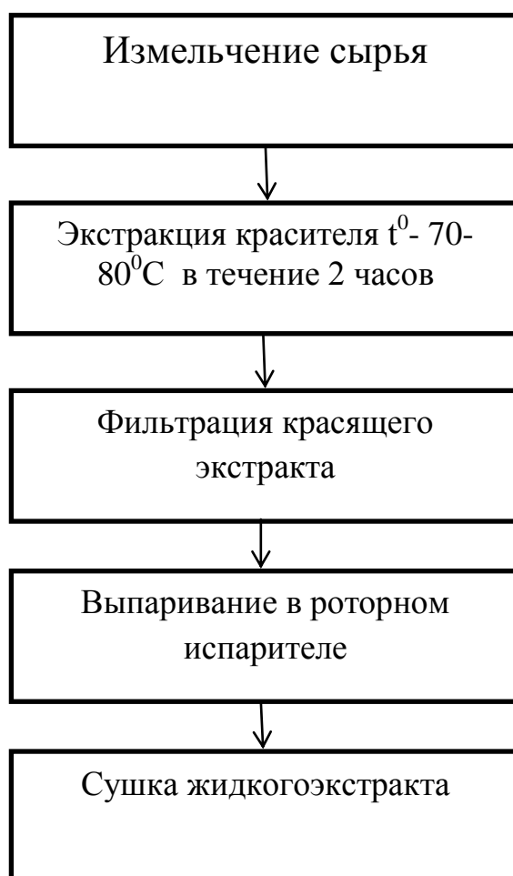
Рисунок 5.3. - Технологическая схема получения красителя из зверобоя
