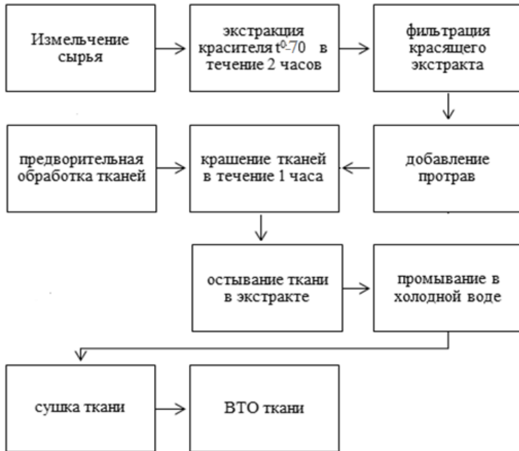
Рисунок 6.20. – Технологическая схема крашения целлюлозных тканей растительными красящими экстрактами протравным методом
