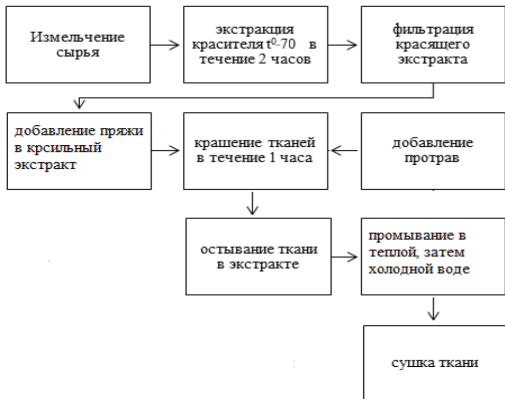
Рисунок 6.22. – Технологическая схема крашения шерсти растительными красящими экстрактами протравным методом
